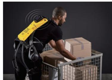
독일 로봇 업체 German Bionic Systems - 웨어러블 로봇 'Clay X'는 이용자가 지탱하는 무게를 30kg 증가시켜 노동자의 피로를 절감할 수 있음
